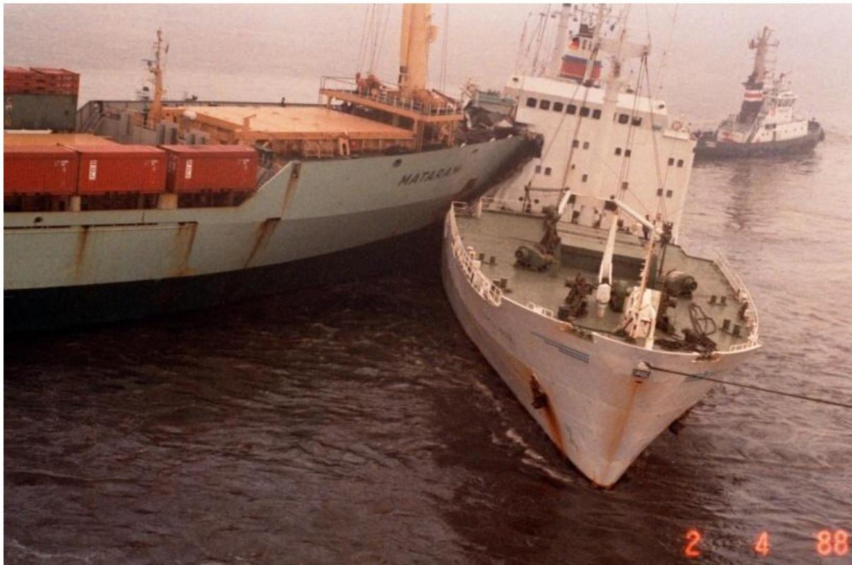
Der Steven der „Mataram“ hatte sich in die Steuerbord-Aufbauten einschließlich des Maschinenraums und des Laderaumes II gebohrt. Beide Schiffe konnten erst nach eineinhalb Stunden durch massiven Schleppereinsatz getrennt werden. Das stundenglasförmige Leck (vom Vorsteven und Wulstbug der „Mataram“) reichte vom Brückendeck bis zum Doppelboden und hatte sofort zum Black Out und damit der Manövrierunfähigkeit der H.H. geführt. Durch auslaufenden Treibstoff kam es auch zu Umweltverschmutzungen.
