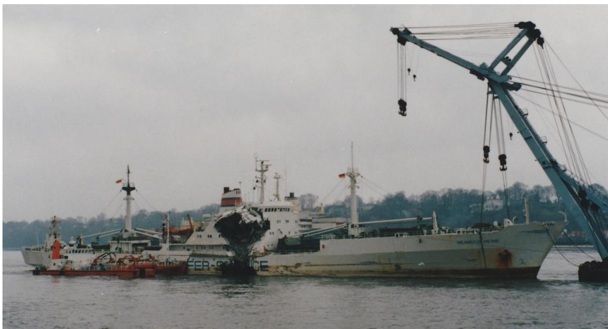
Die „Heinrich Heine“ wurde über den Achtersteven elbaufwärts bis nach Hamburg geschleppt und bei der Werft B & V in das Trockendock 17 bugsiert. Nachdem gegen 20-00 Uhr alle Schlepper, der Schwimmkran und das letzte Ölauffangschiff entlassen waren und das Schiff im Dock sicher auf den Pallungen und trocken lag, atmeten alle auf und die Anspannung legte sich.
